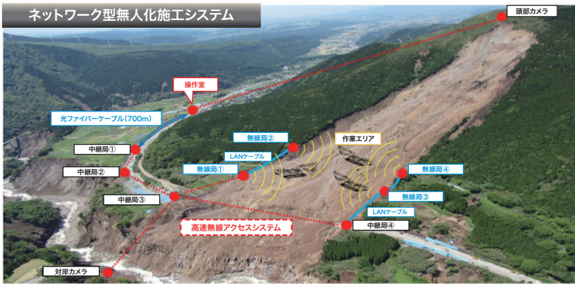
写真-4 ネットワーク型無人化施工システムの概念図
